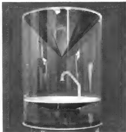
Bild 4. Rundstrahlantenne, bestehend aus einem senkrecht nach oben strahlenden Parabolspiegel und einem im Strahlengang angeordneten Kegelreflektor
