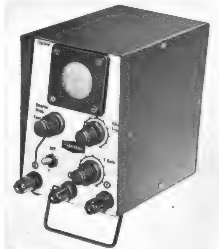
Miniatur-Oszillograf mit 3-cm-Röhre
